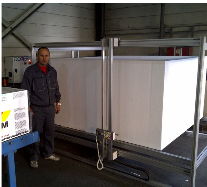
Prva CNC mašina za sečenje stiropora, instalirana 2011. godine, sa jednom žicom za sečenje
