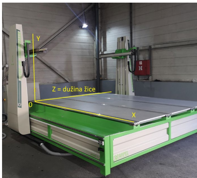
Nova CNC mašina za sečenje stiropora, instalirana 2021. godine, sa maksimalno deset žica za sečenje
